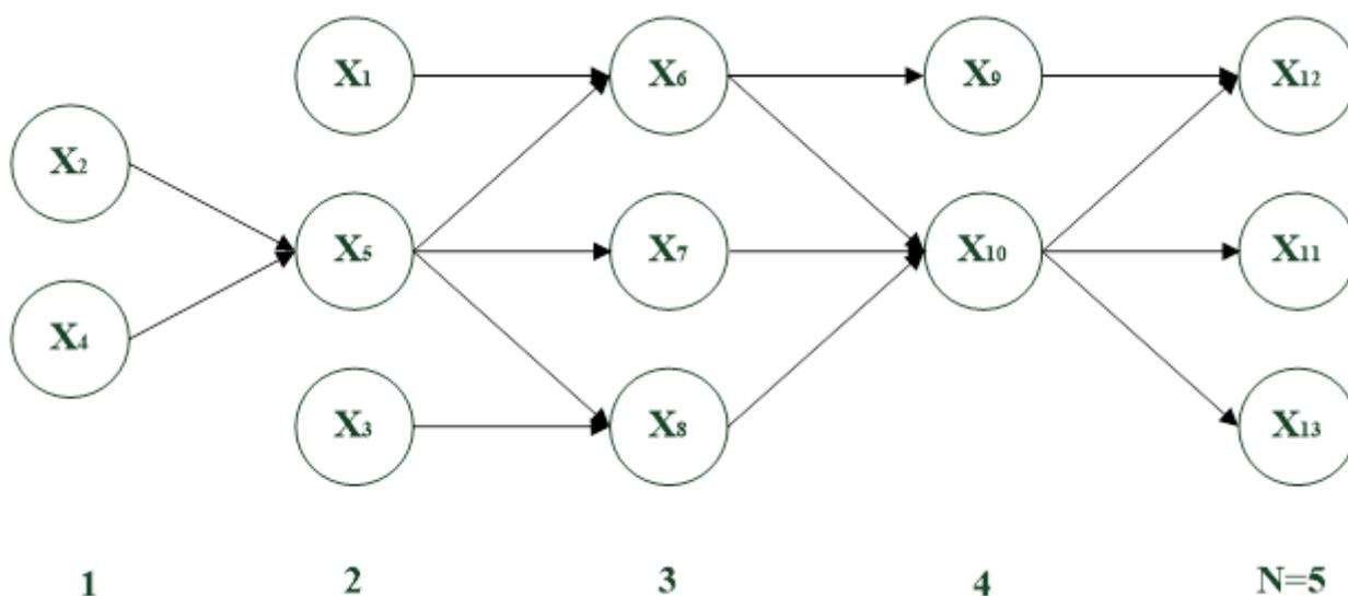
Время решения ЗНЗ при параллельно-последовательной обработке данных в МПСОД, как это следует из графа (см. рис. 1), ограничено сверху некоторыми пороговым критическим значением  $T_{кр}$  и определяется длиной критического пути графа.
