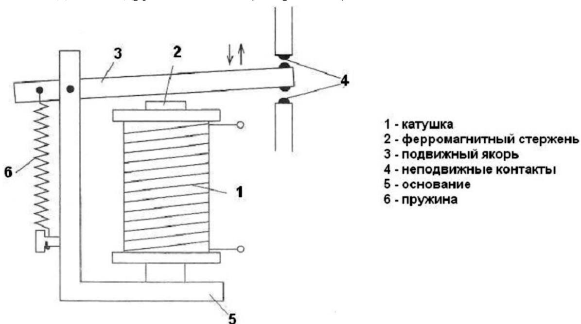
Рисунок 2.1 – Устройство реле
