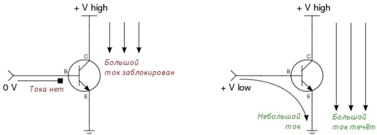
Рисунок 2.2 – Строение и принцип работы транзистора
