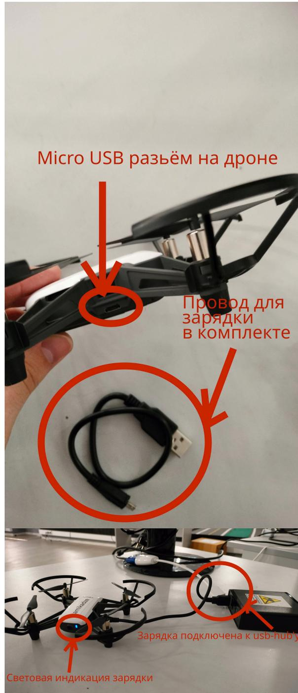
Заряда аккумулятора хватает примерно на 10 минут. При снижении уровня заряда ниже 10% дрон автоматически совершает посадку. Для запуска решений используется только один дрон, остальные используются как зарядные станции: у заряженного и разряженного дронов местами меняются аккумуляторы.
